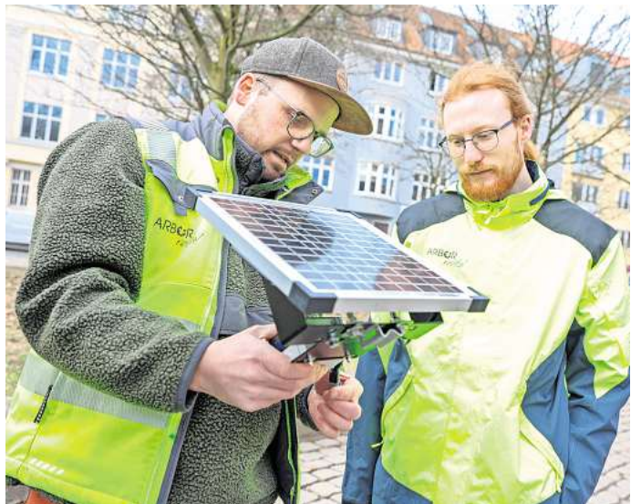
Mitarbeiter des Umweltbüros Arbor revital mit einem Solarmodul, das das Dendrometer mit Energie versorgt.
