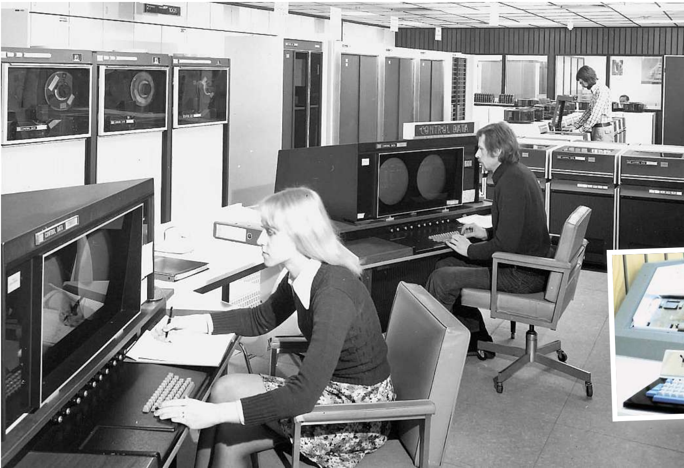
Im Jahr 1975: Die Operateure Daphne Kohlrausch und Hans-Gebhard von Lenthe im Bedienbereich der drei Rechner CYBER 76/73/73. Im Vordergrund die Bedienkonsolen für die beiden CYBER 73-Vorrechner, über die auch die CYBER 76 gesteuert wurde. Dahinter moderne Wechselplatteneinheiten mit je 118 und 236 Mbyte Kapazität – für die damalige Zeit eine große Kapazität, heute ist ein Vielfaches auf einem USB-Stick speicherbar. Die Rechner selbst sind nicht im Bild. Fotos (2): RRZN / Noack
