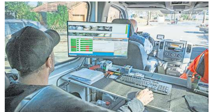
Das Vermessungsfahrzeug „Eagle-Eye“ ist seit Dienstag auf den Straßen der Stadt Laatzen unterwegs. Mit Bild- und Laserkameras erstellt Systemtechniker Renat Djomin ein 3D-Abbild der Laatzen Infrastruktur. Fahrer Udo Rusteberg steuert das Fahrzeug durch die Straßen.
