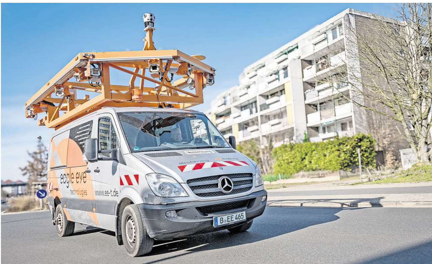
Das Vermessungsfahrzeug Eagle Eye erstellt mithilfe von Bild- und Laserkameras ein 3D-Abbild der Laatzen Infrastruktur.
