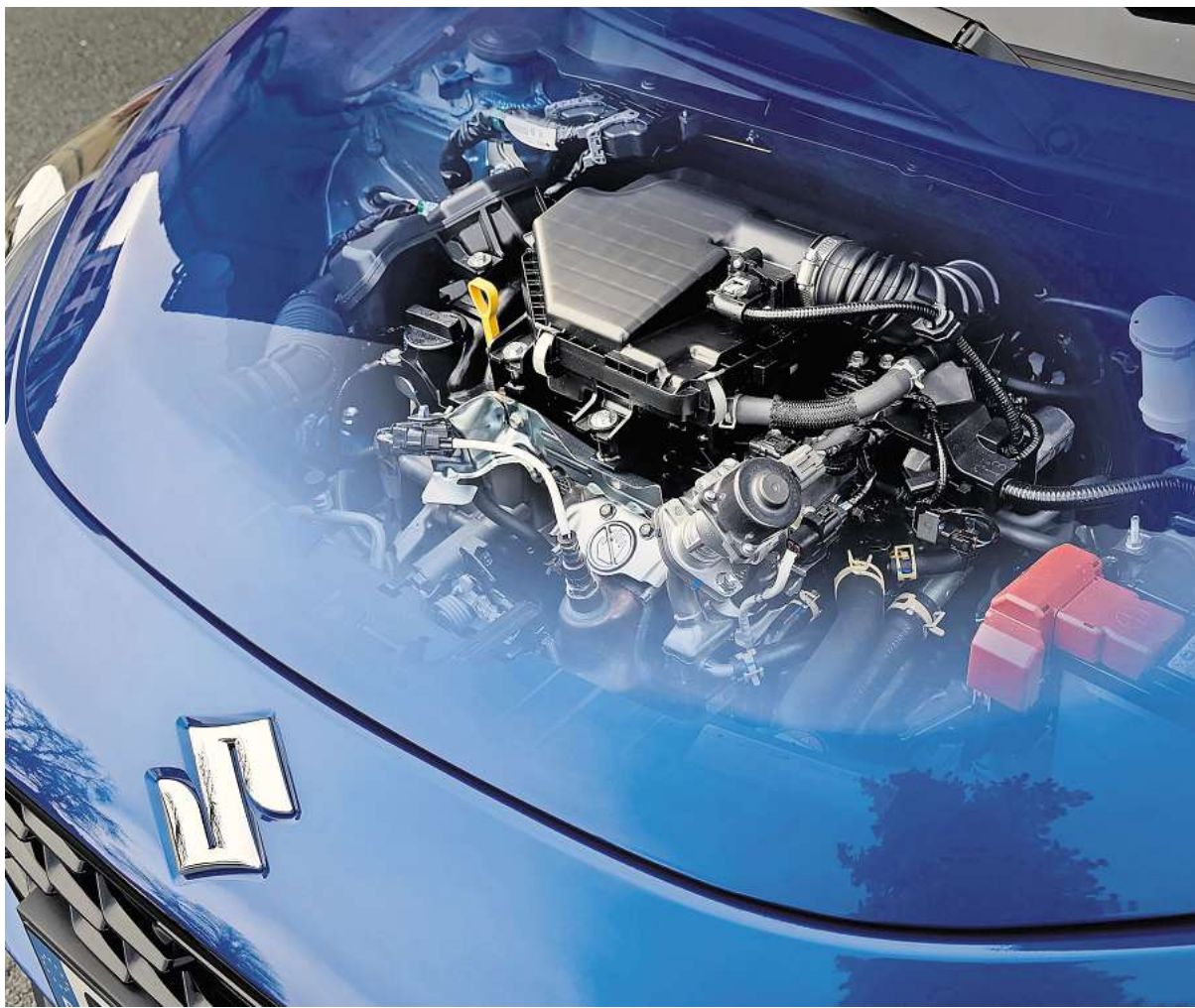
Der neue Suzuki Swift als 1,2-Liter-Dreizylinder-Benziner mit 12-V-Hybrid. Blick unter die Motorhaube des neuen Suzuki Swift: Neuer 1,2 Liter-Dreizylinder-Benziner mit 12-V-Hybrid.
