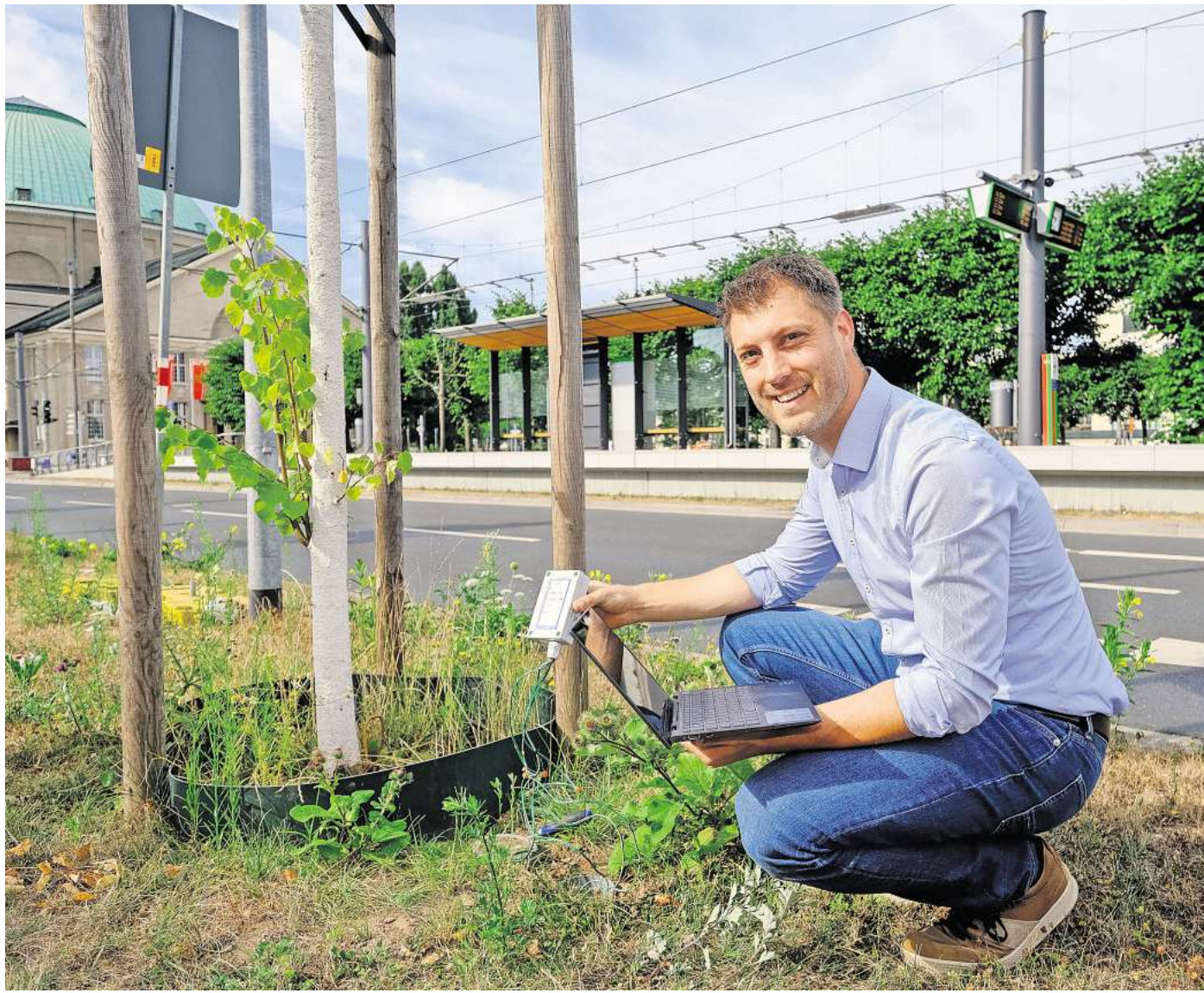
Alles digital: Mit Sensoren im Boden kann Manuel Kornmayer auf dem Laptop sehen, wie es um die Bodenfeuchte am Theodor-Heuss-Platz bestellt ist – wichtig auch für die Vorbeugung gegen Folgen von Starkregenereignissen. Foto (Archiv): Tim Schaarschmidt
