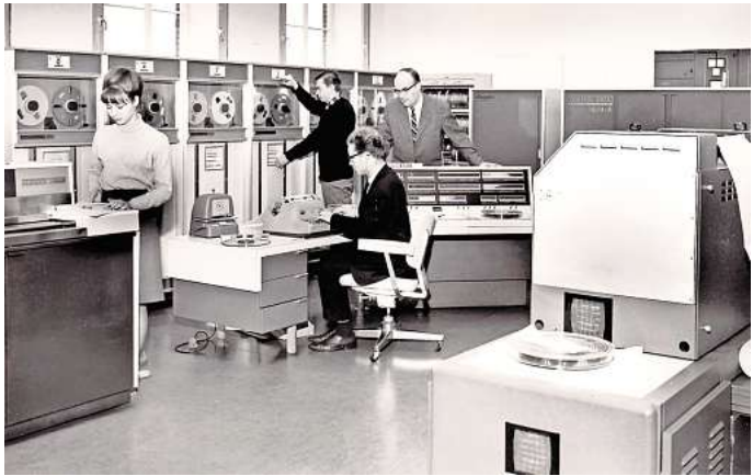
Die Anfänge des Rechenzentrums: Die Zentraleinheit der CDC 1604-A im Jahre 1965, davor die Bedienungskonsole mit Schreibmaschine, an der der damalige Hilfsassistent Hans-Jürgen Hille sitzt, der Abteilungsleiter im späteren RRZN wurde. Weitere Personen im Bild (v.l.): Heide Lore Pannke, Dieter Behrens und Manfred Römermann.
