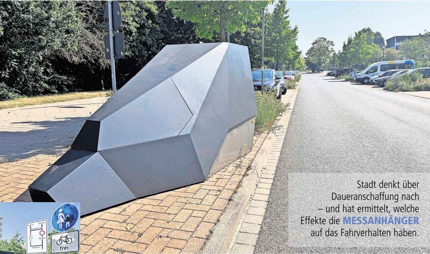
Die Stadt Laatzen testet seit Ende August den Einsatz einer semistationären Geschwindigkeitsmessanlage. Der Aufstellort des mobilen Blitzers kann flexibel gewählt werden.
