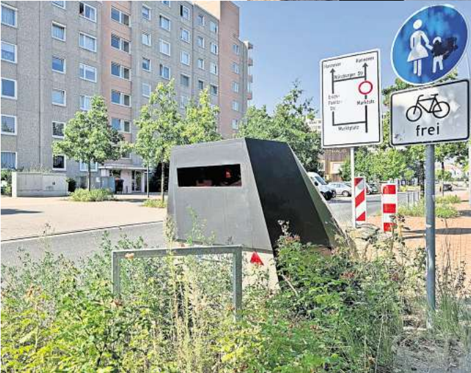
Die Stadt Laatzen testet seit Ende August den Einsatz einer semistationären Geschwindigkeitsmessanlage. Der Aufstellort des mobilen Blitzers kann flexibel gewählt werden.
