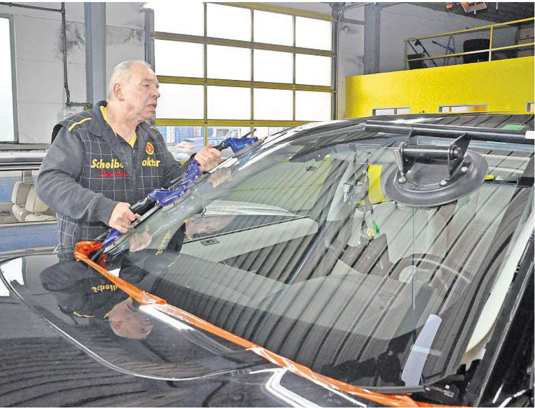
Nach dem Scheibeneinbau müssen die Fahrerassistenzsysteme neu kalibriert werden.
