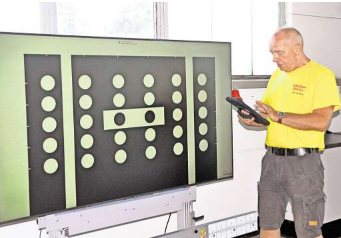
Nach dem Scheibeneinbau müssen die Fahrerassistenz-Systeme neu kalibriert werden
